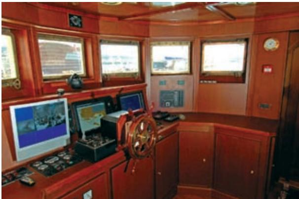
Lijevo: kormilarnica, na lijevom ekranu vide se snimke internih TV kamera, a desni ekran pokazuje elektroničku navigacijsku kartu.
